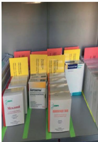
Рис. 1. Пример карточного канбан
